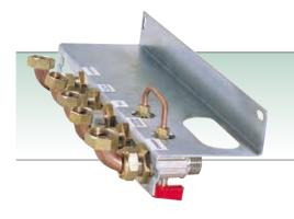
L'utilizzo della placca raccordi consente di collaudare le tenute idriche dell'impianto prima di installare la caldaia. La placca è dotata infatti di rubinetti di intercettazione a tre vie idonei a svolgere tale funzione.
